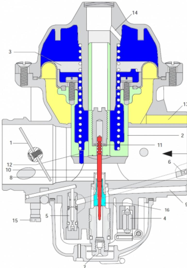
Fälschlicherweise wird angenommen, dass die Membrane ja in Abhängigkeit des Druckes im Venturirohr<sup>1)</sup>, hier auch für eine Anpassung des Gemisches sorgt. Die Funktion der Rollmembran(3) ist jedoch ausschließlich für das Anheben des Vergaserschiebers(2) in Abhängigkeit der Stellung der Drosselklappe(1) zuständig.
