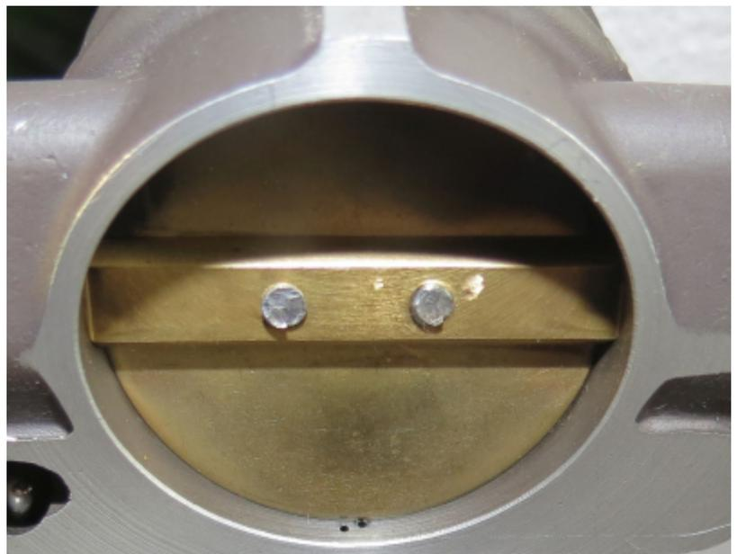
Ist die Drosselklappe, wenn sie komplett am Anschlag (also im Leerlauf) ist, im unteren Bereich des Vergasers, also im Bereich der Übergangsbohrungen, nicht richtig zentriert, fettet der Motor durch die erhöhte Freigabe der Übergangsbohrungen verstärkt an.
