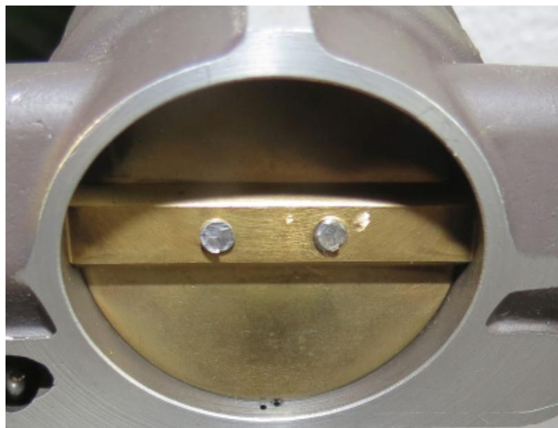
Ist die Drosselklappe, wenn sie komplett am Anschlag (also im Leerlauf) ist, im unteren Bereich des Vergasers, also im Bereich der Übergangsbohrungen, nicht richtig zentriert, fettet der Motor durch die
