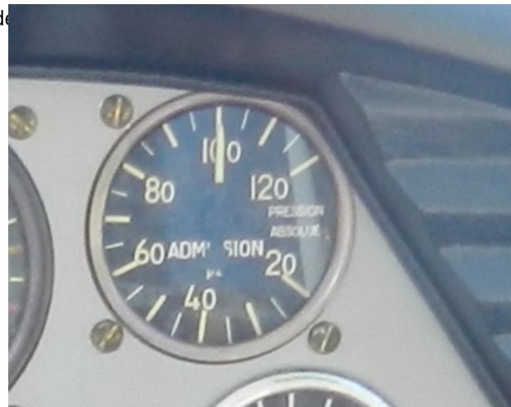
Das Instrument ist leider nicht für einen Rotax verwendbar und mir scheint, dass es sich hierbei um eine Ladedruckanzeige mit einer auf den Motor abgestimmten Skala handelt. Wie man sieht, zeigt es bei stehendem Motor 100% an, was dem Umgebungsdruck entspricht.
