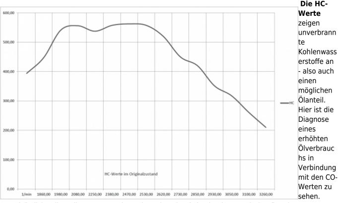
Grundsätzlich sollten die CO-Werte aber schon einmal auf eine intakte Gemischaufbereitung (Vergaser) schließen lassen.
