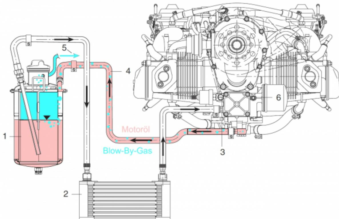
Wie erzeugt man nun genug Blow-By-Gas um im Stand des Motors das Öl aus dem Kurbelgehäuse in den Ölbehälter zu fördern?
