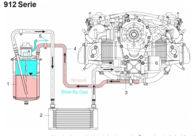
Wie erzeugt man nun genug Blow-By-Gas um im Stand des Motors das Öl aus dem Kurbelgehäuse in den Ölbehälter zu fördern?
