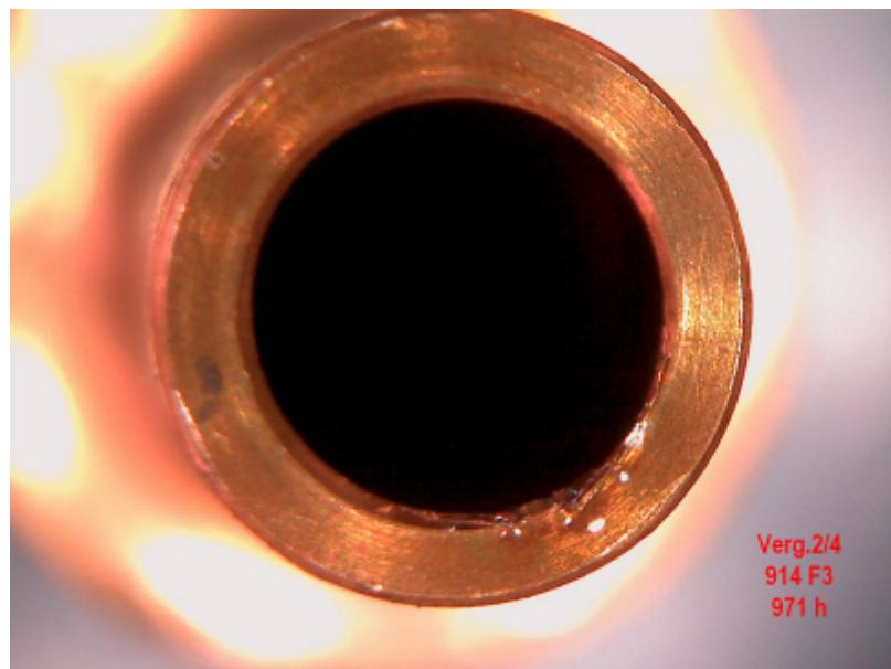
Deutlich zu sehen ist bei den Nadeldüsen **mit 206 Betriebsstunden** ein aufgebördelter Rand, welcher durch das ständige Schlagen der Düsennadel bei Vibrationen des Vergasers entsteht. Die Nadeldüsen **mit 971 Betriebsstunden** eines 914er Turbao zeigen ganz deutlich, dass selbst ein Motor mit fest verbauter Airbox starken Verschleiß an den Nadeldüsen aufweisen kann. Man kann sich vorstellen, dass die Vergaser eines Motors ohne Airbox einen noch viel höheren Verschleiß zeigen können.
