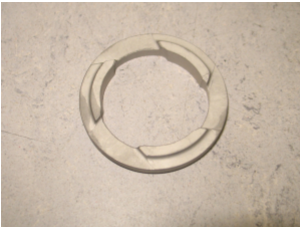
1.Bild: Prototyp der Stufenhülse - 2. und 3. Bild: Die endgültige Form.
