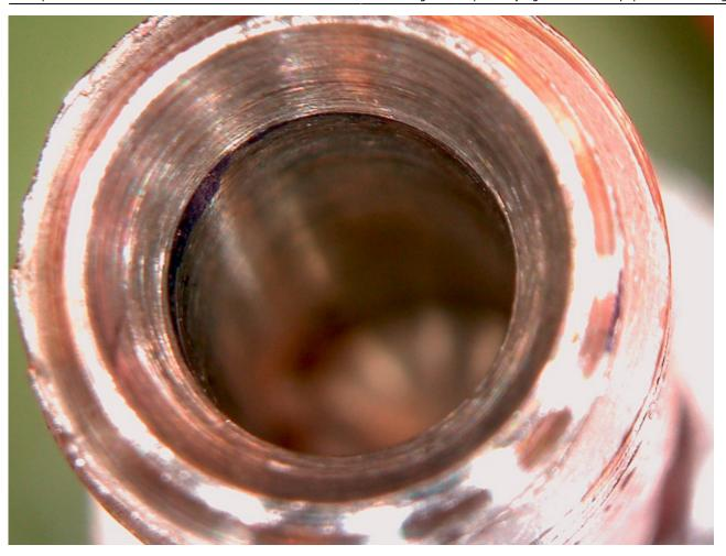
Das Bild zeigt den konischen Ventilsitz in der Hohlschraube. Man kann sich vorstellen, dass hier eine Undichtigkeit vorprogrammiert ist.
