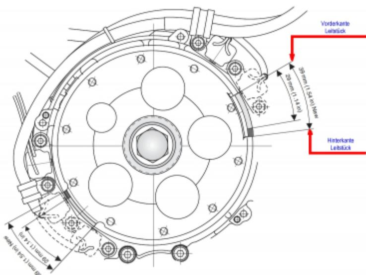
Beim Anlassen des Motors, bei einer Anlassdrehzahl von ca. 350 U/min durch den Anlasser, wird dieser Impuls an der Hinterkante der Leitstücke ausgelöst. Das war bei der älteren Ausführung der Magnetnabe  $4^\circ$  vor OT und ist bei der Magnetnabe für die Softstartmodule  $3^\circ$  Nach OT.
