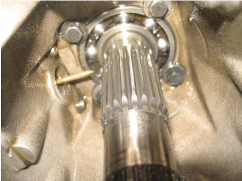
Nach eingehender Beratung hat Edi eine entsprechende Hülse gedreht und ich habe eine Spritzdüse gebastelt, die bei der Bohrung für die Kraftstoffpumpe montiert und vom Anschluss der Druckleitung für den hydraulischen Verstellregler gespeist wurde.
