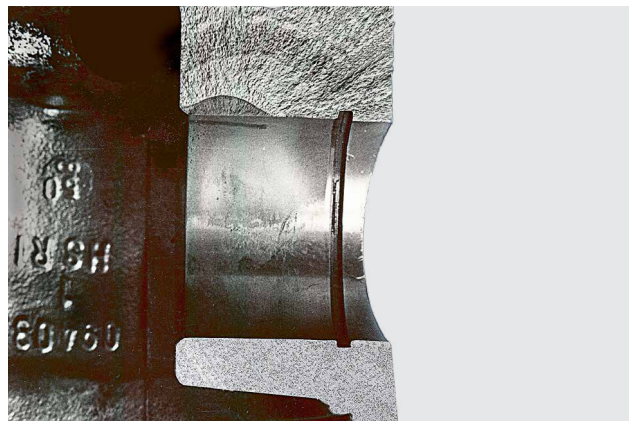
Abb. 3: Querschnitt einer Kolbenbolzennabe
